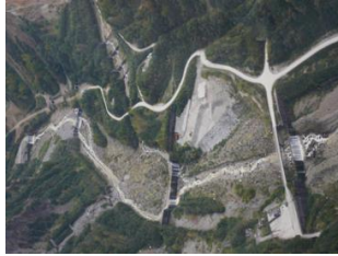
土石流災害を防ぐための砂防ダム
